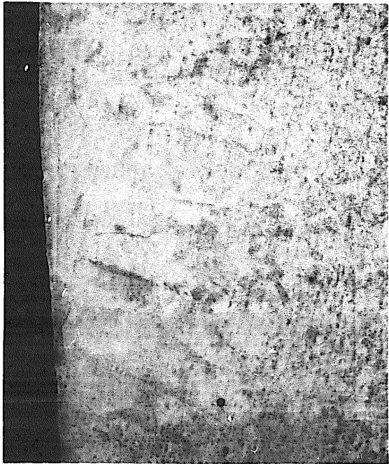
写真- 4(1) 溶接試験試料の金相 (エッチング後)
