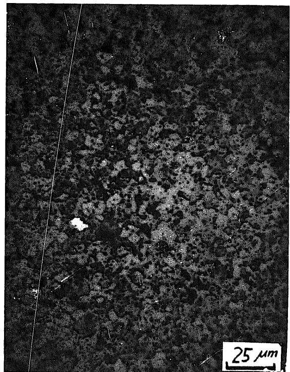
図8 焼結ペレットの断面金相写真 混合 UO_2 (回収 UO_2 /従来 UO_2 = 1/1)
