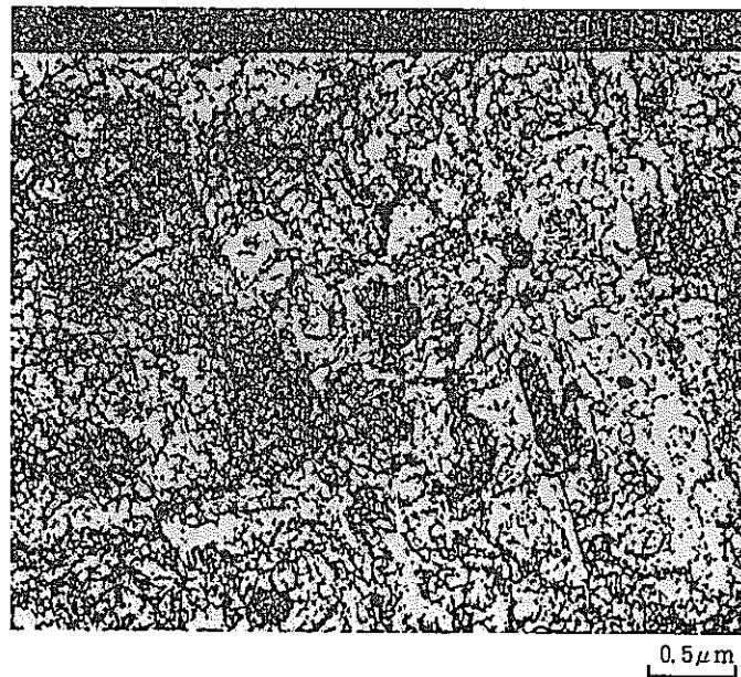
写真-2 MA957鋼組織の1t板受領材の電顕写真
