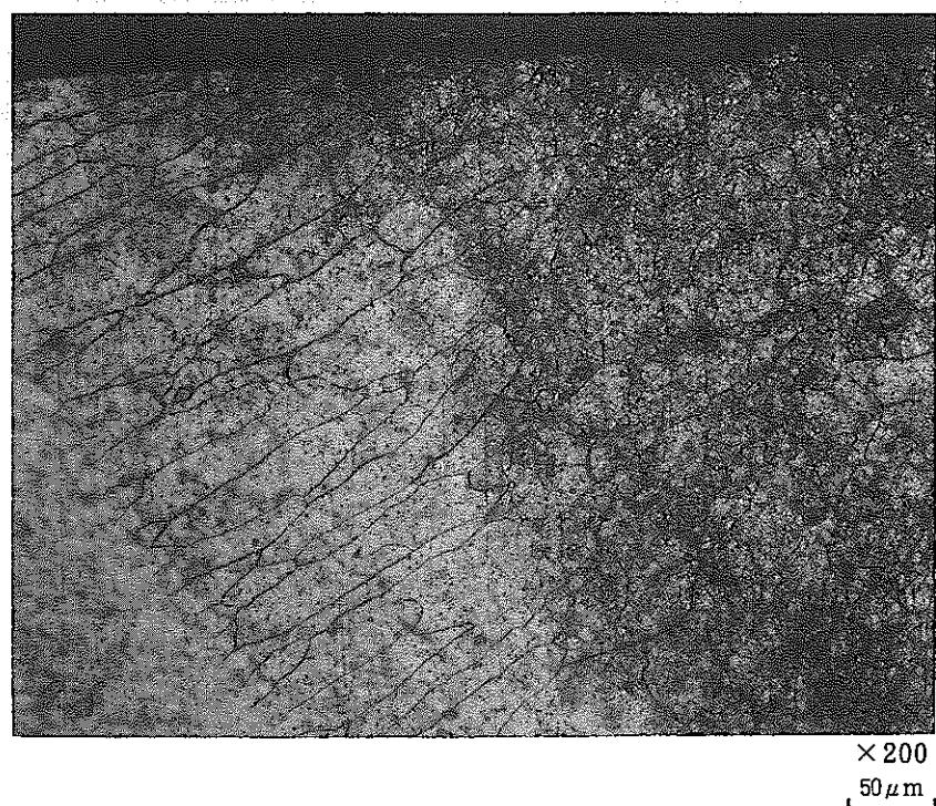
写真-6 MA 956 溶接金属部断面金相写真（パルスTIG溶接）
