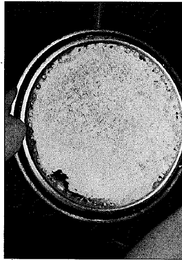
写真17 真空サポート（内側）の付着ナトリウムの潮解状況（空气中8分後）
