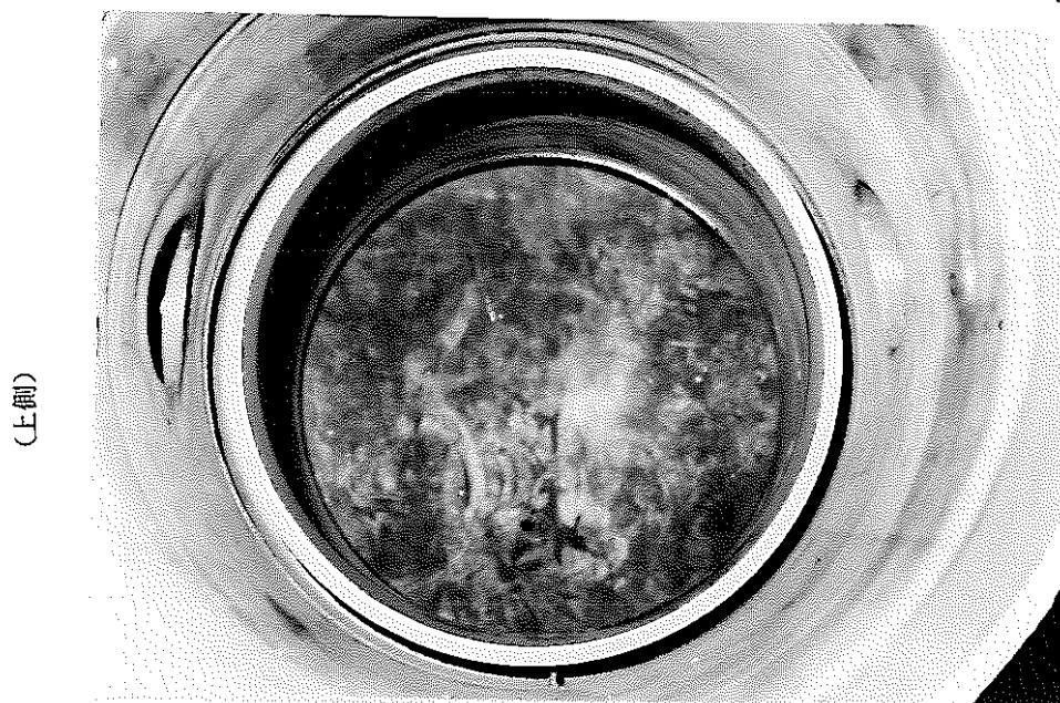
写真 5-18 定盤による弁座当たりの状況 Photo 5-18 Contact mark of valve seat with a surface plate
