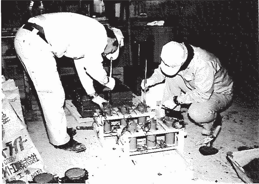
写真 - 5 試験体の成型状況（熱伝導率（円筒法）試験体）
