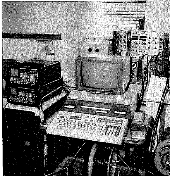
図4.2.5 中性子計測システム (電子回路とデータ処理システム)
