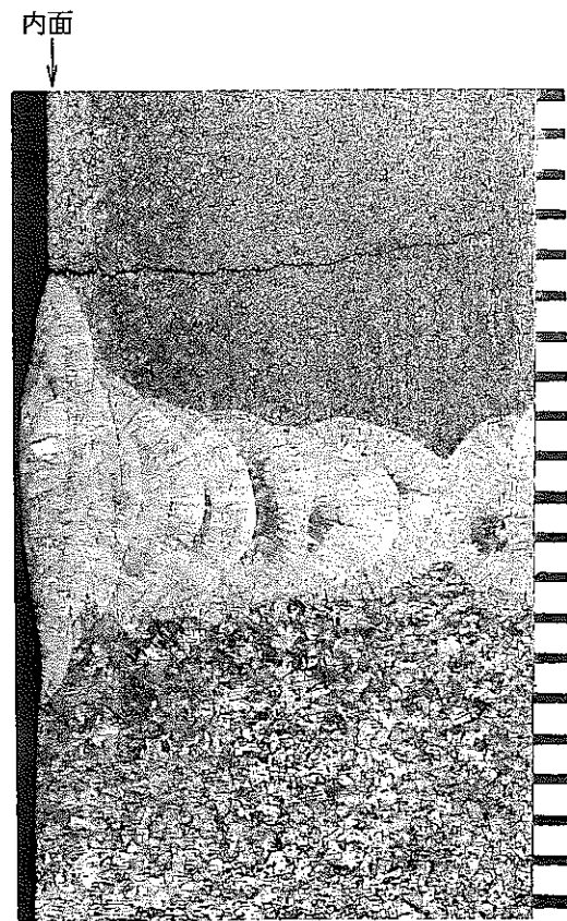
③ 外部胴下部周溶接部縦断面
