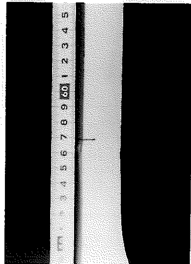
④ 外胴-支持スカート溶接部縦断面
