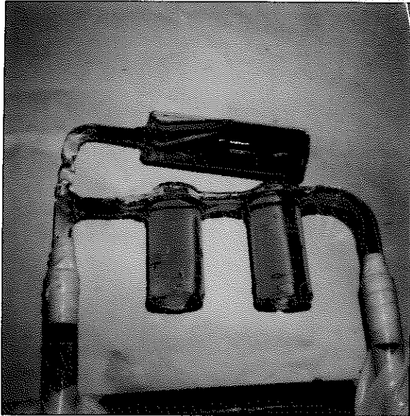
フラッシング初期のNaが空気タンク及び試料タンクへ流れ込んだ状況（ステップ1）
