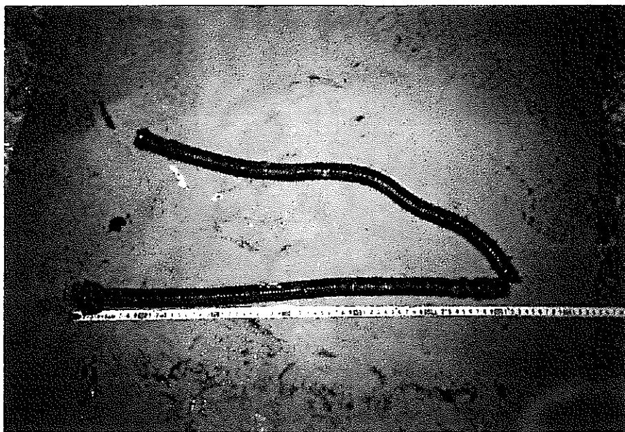
写真 20 実験後のフレキシブルチューブ（洗浄後）
