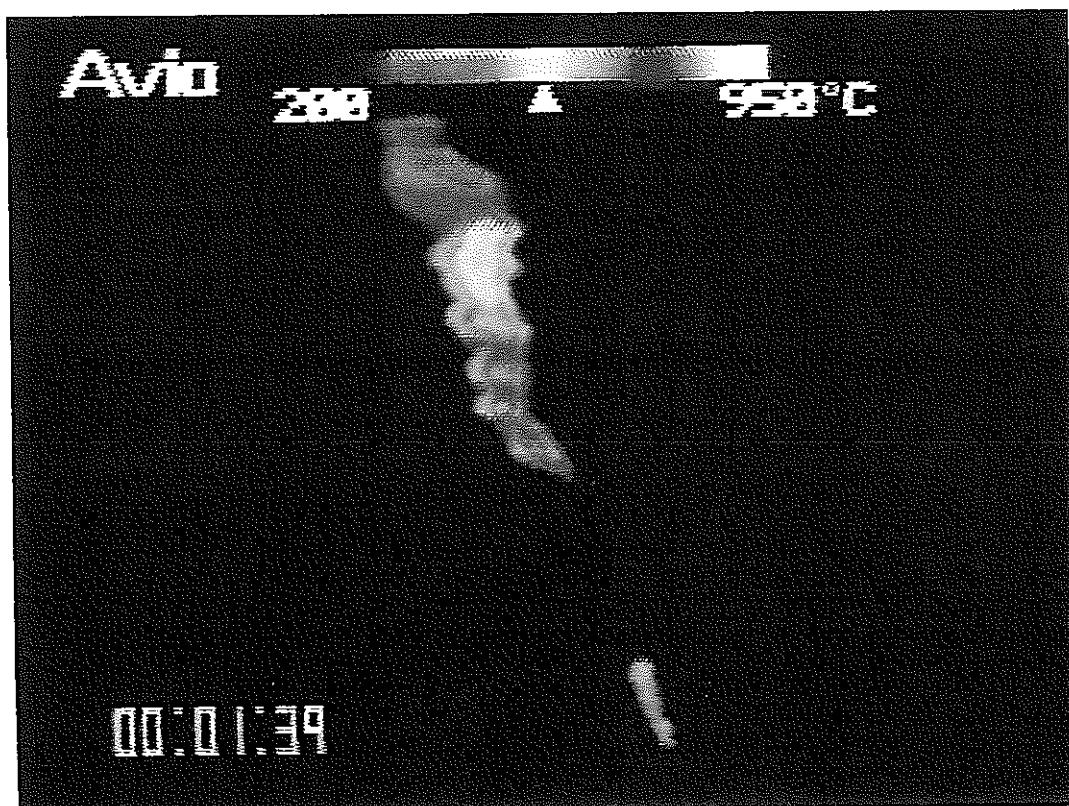
写真9 赤外線カメラによる模擬漏えい部におけるナトリウム漏洩状況
