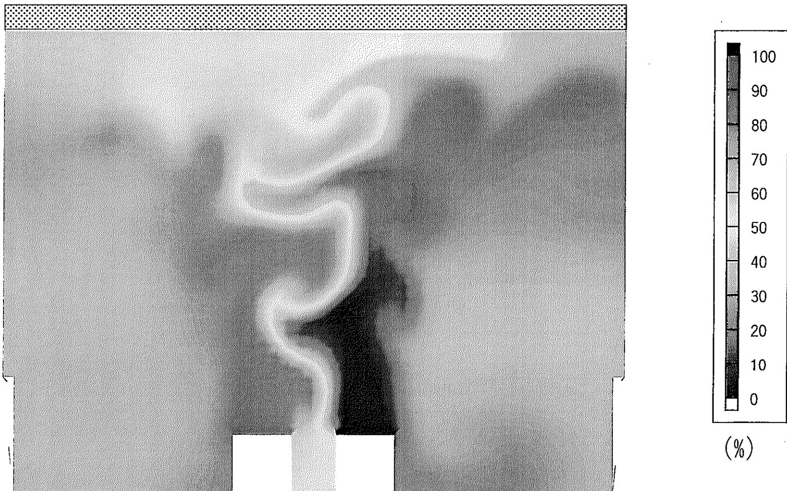
図3.19 DINUS-3コードによる瞬時ナトリウム温度分布（ケース2）
