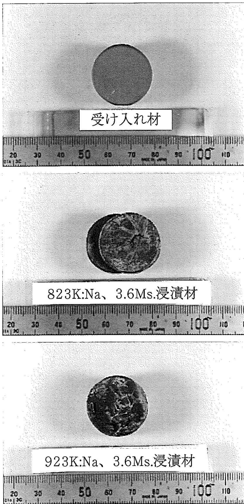
図10. ナトリウム浸漬前後のAl 2 O 3 /SUS傾斜機能材料の外観写真.
