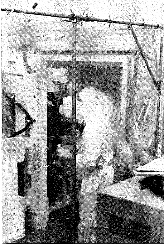
(a) かたさ計除染作業
