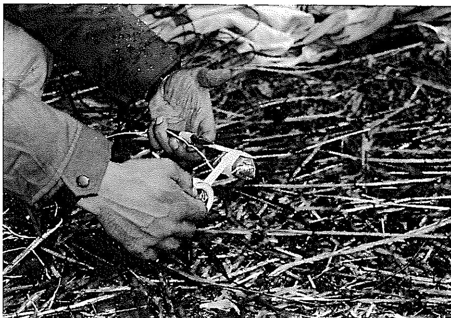
図-4-2-3 発破震源の装薬作業
